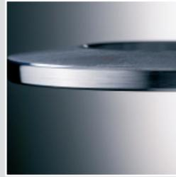
精密加工过的表面. 纵向细沟痕纹完全清除. 车工纹方向和主要张力方向一致, 没有发生破裂的危险
