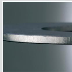
滚动研磨时, 清除部份纵向细沟纹, 表面比较光滑.
