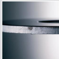
冲孔后, 纵向细沟纹横切过切线张力方向, 产生切口效应. (如图1)
